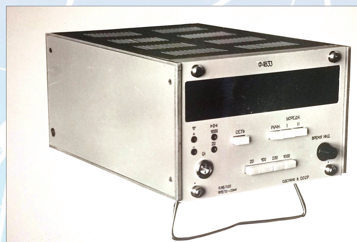
Аналого-цифровий перетворювач з ваговим двотактним інтегруванням типу Ф4833 (розроблений за участі О. Чайковського і М. Дорожовця) та Цифровий вольтметр з ваговим двотактним інтегруванням типу Ф4834 (розроблений за участі О. Чайківського, М. Дорожовця, О. Івахіва)
