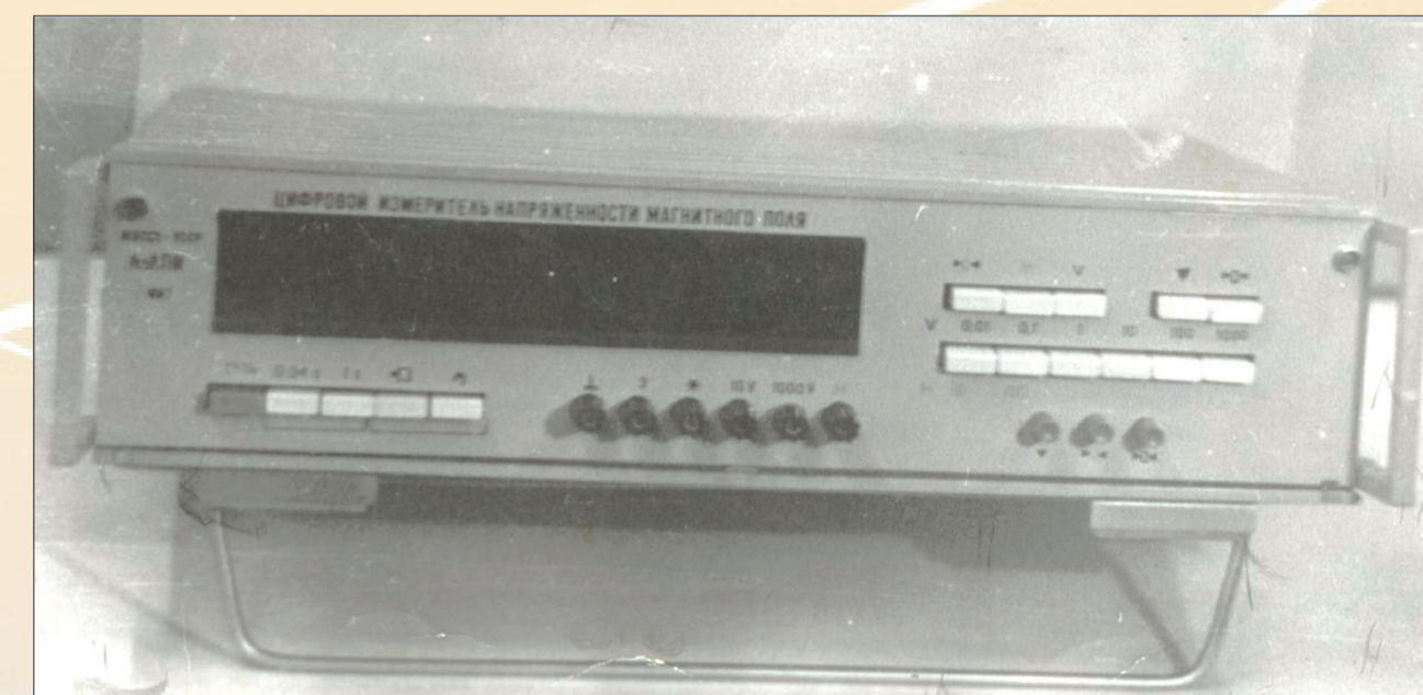
Цифровий вимірювач магнітного поля (автори Грибок М., Дорожовець М., Питель І., Тищенко Л.)
