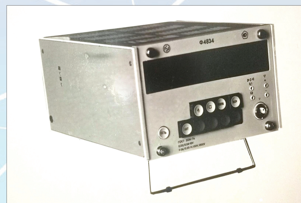
Аналого-цифровий перетворювач з ваговим двотактним інтегруванням типу Ф4833 (розроблений за участі О. Чайковського і М. Дорожовця) та Цифровий вольтметр з ваговим двотактним інтегруванням типу Ф4834 (розроблений за участі О. Чайківського, М. Дорожовця, О. Івахіва)
