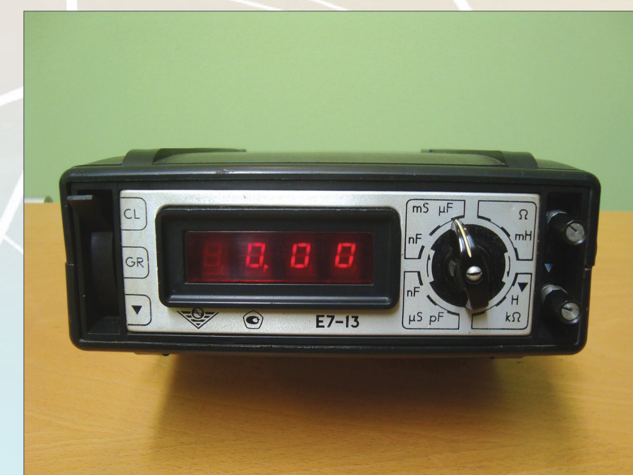
Малогабаритний цифровий вимірювач CLR E7-13 (автори: Гаврилюк М.О., Походило Є.В., Соголовський Є.П., Хома В.В.)
