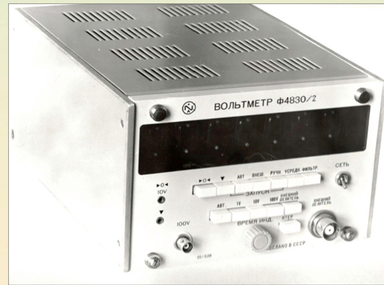
Цифровий вольтметр Ф4830/2 (розроблений за участі М. Дорожовця М. та О. Чайковського)
