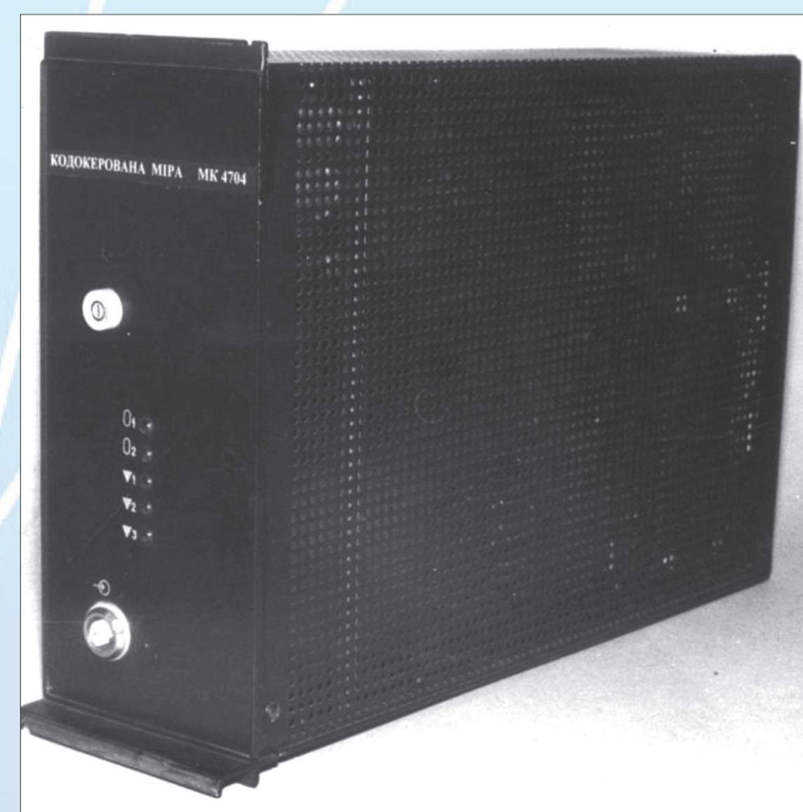
Калібратор-імітатор опору, напруги та струму типу МК4703 (розроблений за участі О. Бойко, П. Столярчука, В. Яцука) та Кодокерована міра опору, напруги та струму типу МК4704 (розроблений за участі О. Бойко, П. Столярчука, В. Яцука)
