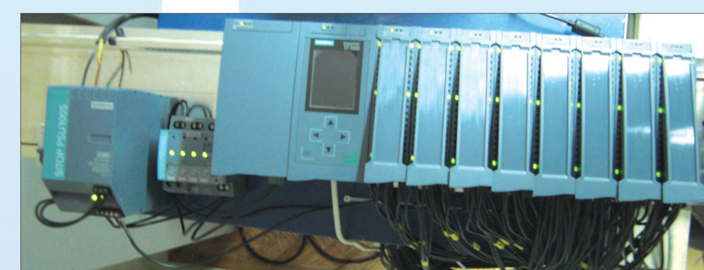
16-елементний планарний сенсор температури з лінійними резистивний чутливими елементами та 16-канальна система збирання вимірювальних даних з цього сенсора на базі модулів Siemens SIMATIC S7-1500/ET 200MP (Analog input module AI 8xU/I/RTD/TC ST) (автори М. Дорожовець та М. Бурдега)
