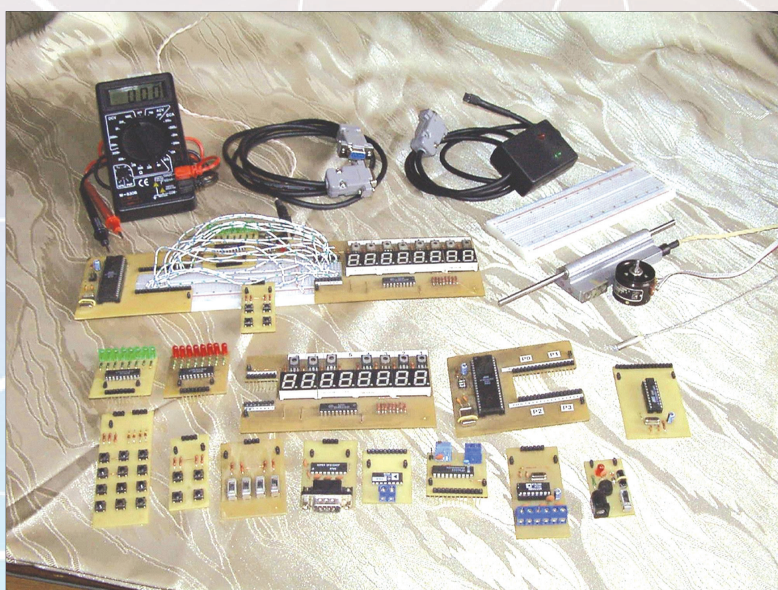
Універсальний комплект для вивчення студентами основ цифрової техніки, мікропроцесорної техніки та засобів передачі вимірювальних даних до комп'ютерів (автори Питель І.Д., Озгович А.І.)
