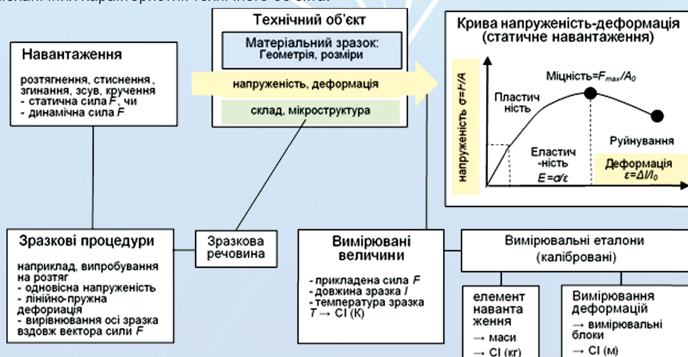
Поєднання вимірювань та випробувань для визначення механічних характеристик технічного об'єкта
