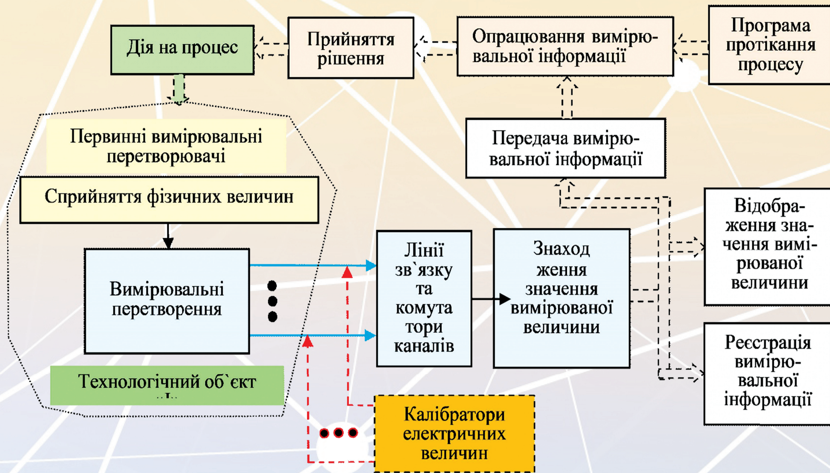
Оперативне контролювання розпорощених вимірювальних систем на основі переносних калібраторів електричних величин
