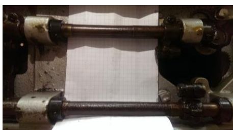
Рис. 1. Вали із забрудненнями у вузлах ковзання
