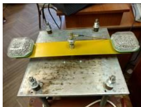
Рис. 2. Загальна (об'ємна) схема причепа з місцями болтових з'єднань (1-11(а), стенд для моделювання вібраційних процесів у баку причепа з зерном
