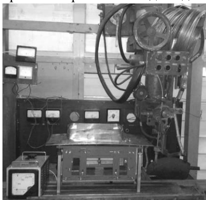
Рис. 3. Вигляд обладнання для наплавлення зносостійких шарів під шаром флюсу з використанням розробленого віброударного модуля
