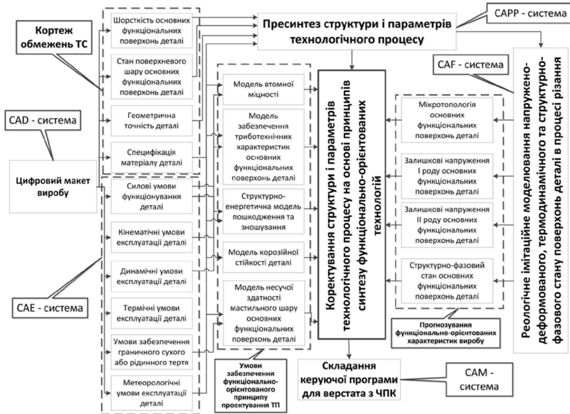
Рис.2. Узагальнений алгоритм функціонування CAF-системи у структурі інтегрованої системи технологічної підготовки виробництва (CAD/CAPP/CAM)
