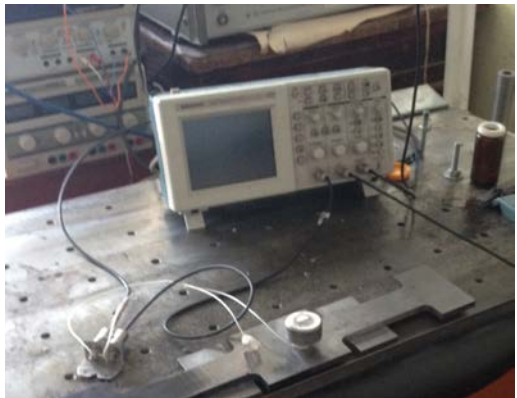
Рис.8. Експериментальна установка для визначення залишкових напружень акустопружним методом
