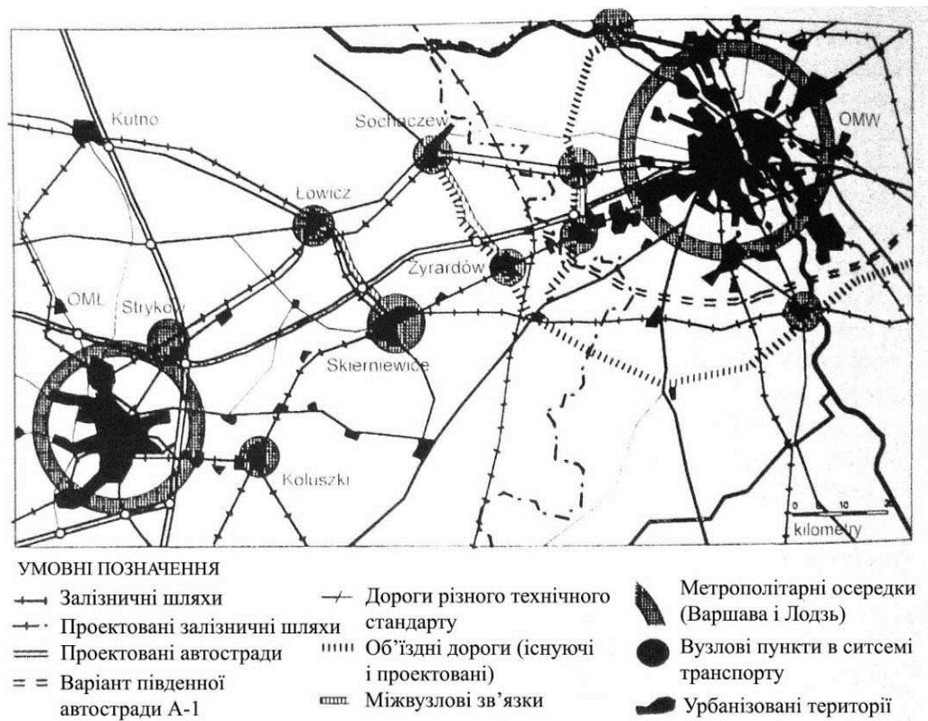
Рис. 61. Комунікаційні зв'язки нового покоління (автостради, залізниці) двох метрополітарних осередків центральної Польщі: Варшава і Лодзь в стані біполярної конурбації з взаєморозташуванням функцій [142].
