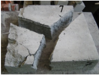
Рис. 3. Характерні вигляди пінобетонних плит після випробувань
