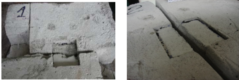
Рис. 4. Осідання штампу в пінобетоні плит
