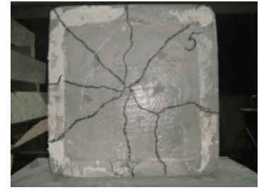
Рис. 3. Характерні вигляди пінобетонних плит після випробувань
