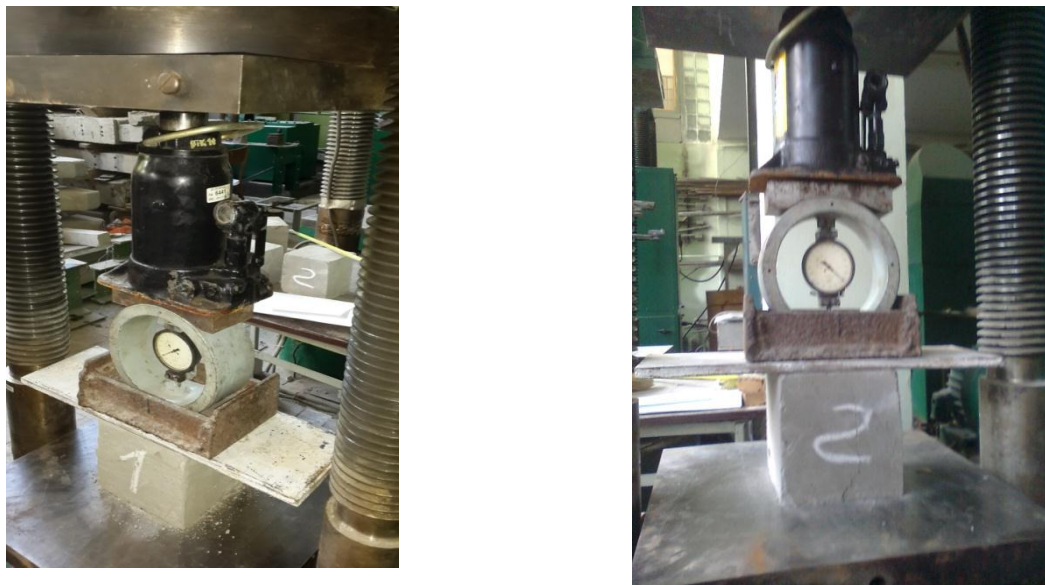
Рис. 2.13. Випробування пінобетонних кубів
