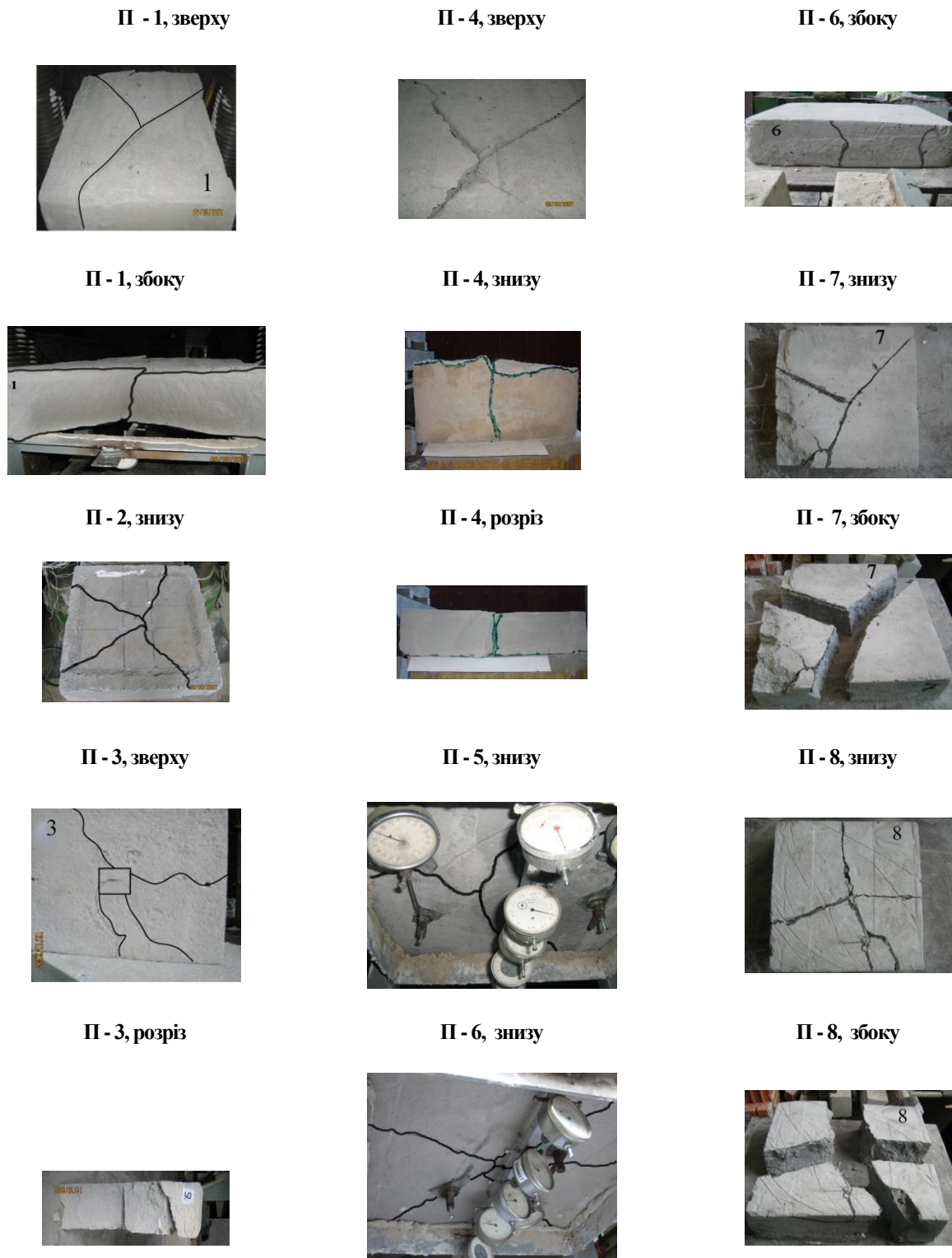
Рис. 3.2. Вигляди плит марок П-1...8 після випробувань.
