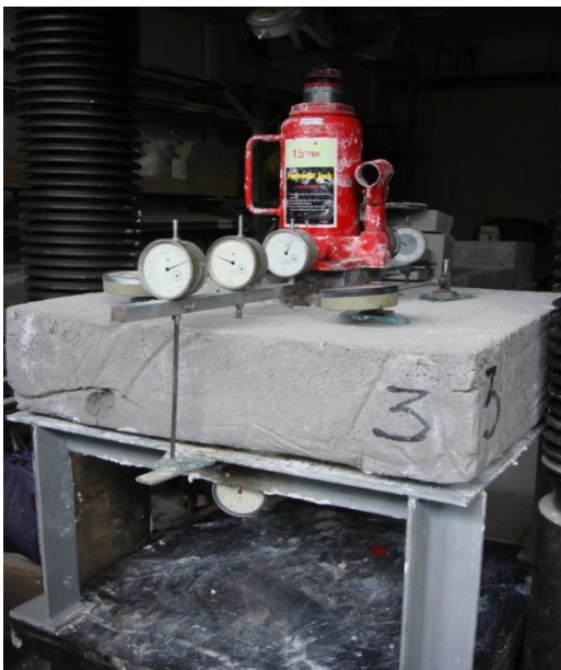
Рис. 3.1. Вигляд плити марки П-3 в процесі випробування:
