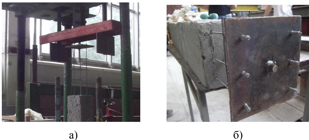
Рис. 2.17. Спеціальні опорні пластини: а) схема; б) вигляд
