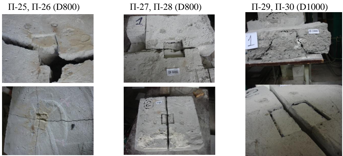
Рис.3.8. Осідання штампу в плитах П-25...П-30
