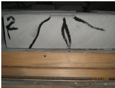
Рис. 3.18. Вигляд плити марки П-16 після руйнування:
