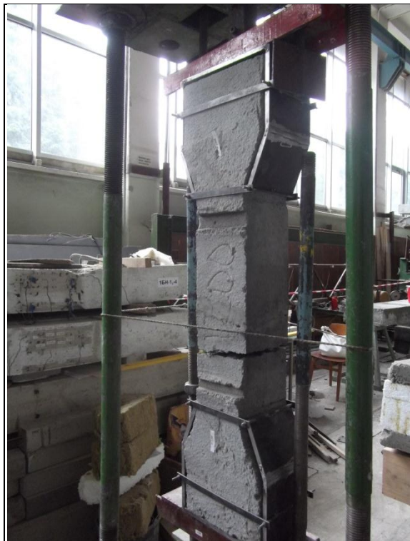
Рис. 3.33. Вигляд руйнування дослідних зразків «вісімок» на розтяг.
