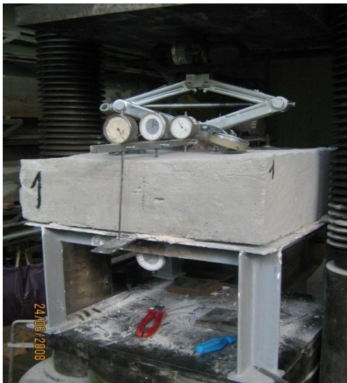
Рис. 3.16. Вигляд плити марки П-15 в процесі випробувань:
