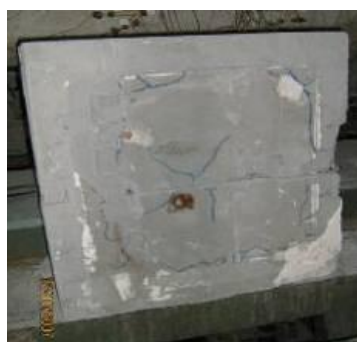
Рис. 3.12. Вигляд плит марок П-10 та П-11 після руйнування:
