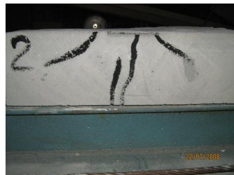
Рис. 3.18. Вигляд плити марки П-16 після руйнування:
