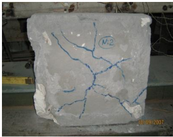
Рис. 3.13. Вигляд плити марки П-12 після руйнування:
