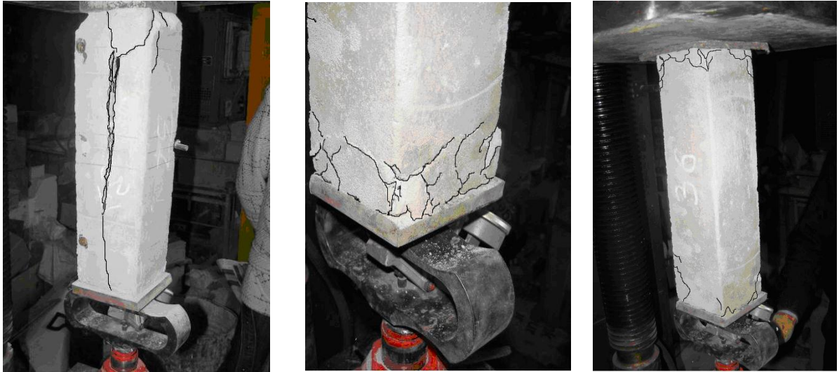
Рис. 3.30. Руйнування дослідних зразків призм.
