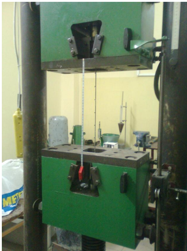
Рис. 2.24. Вигляд розривної машини з металевою арматурою.
