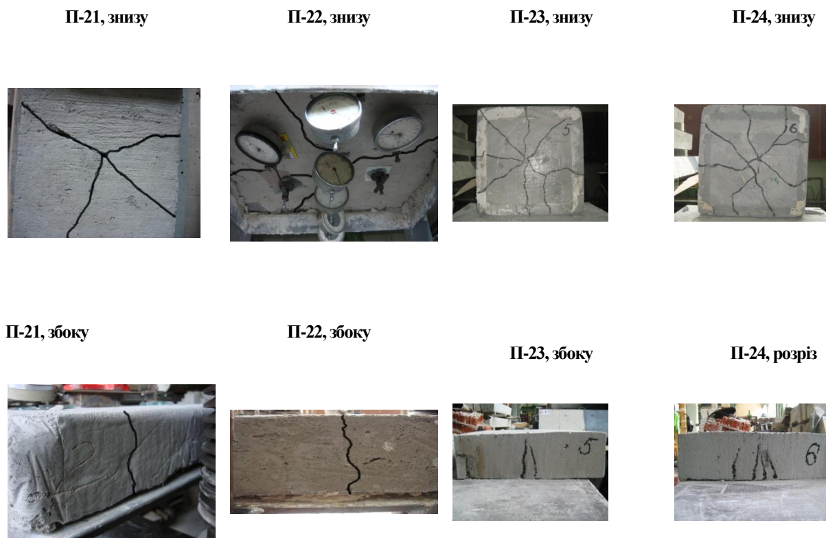
Рис. 3.3. Вигляди плит марок П-21...24 після випробувань.
