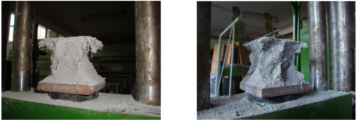
Рис. 3.28. Руйнування дослідних зразків кубів з пінобетону, армованого фіброю.
