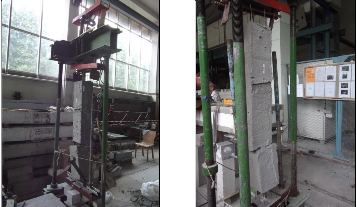
Рис. 3.34. Вигляд руйнування дослідних зразків призм на розтяг.
