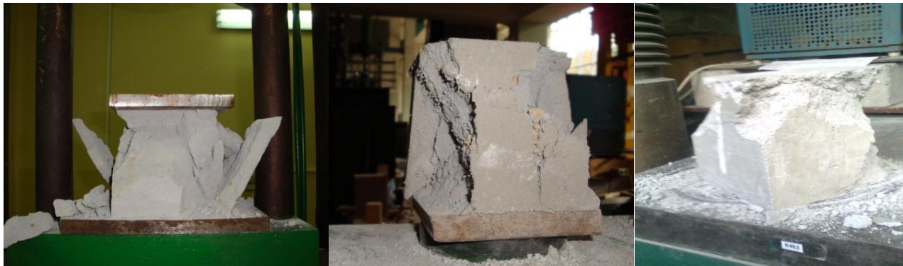
Рис. 3.27. Руйнування дослідних зразків кубів.
