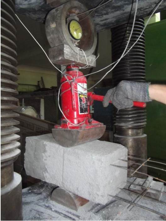
Рис. 3.37. Вигляд руйнування дослідних зразків призм на розколювання.
