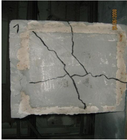
Рис. 3.17. Вигляд плити марки П-15 після руйнування:
