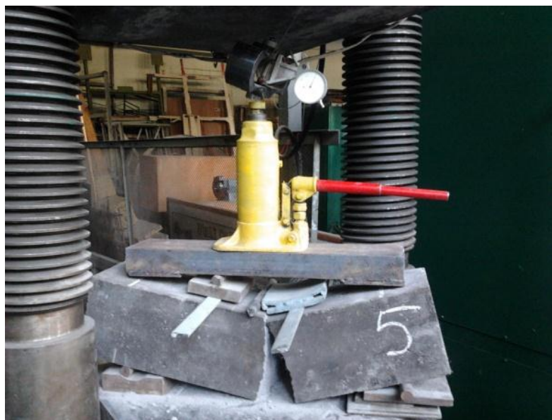
Рис. 3.39. Вигляд руйнування дослідних зразків від згину.
