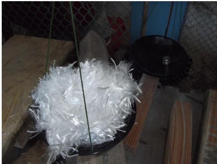
Рис. 2.1. Поліпропіленове волокно (фібра).
