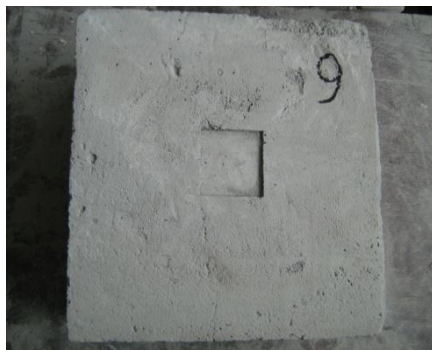
Рис. 3.19. Вигляд плити марки П-17 після руйнування: а) зверху; б) знизу.
