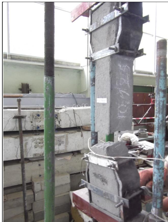
Рис. 3.33. Вигляд руйнування дослідних зразків «вісімок» на розтяг.
