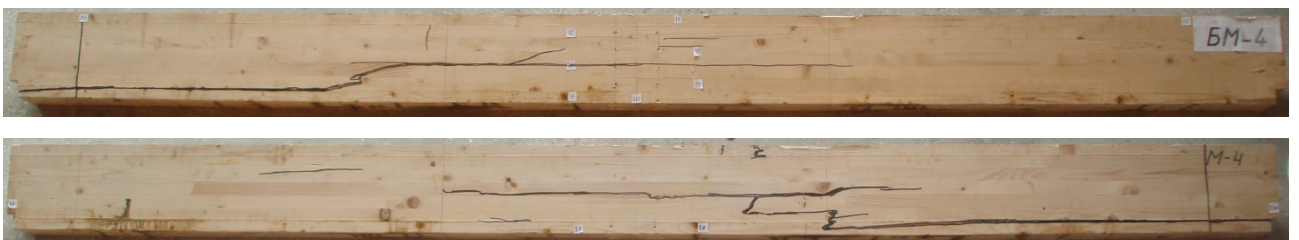
Рис. Г.10. Характер руйнування балки марки БМ-4
