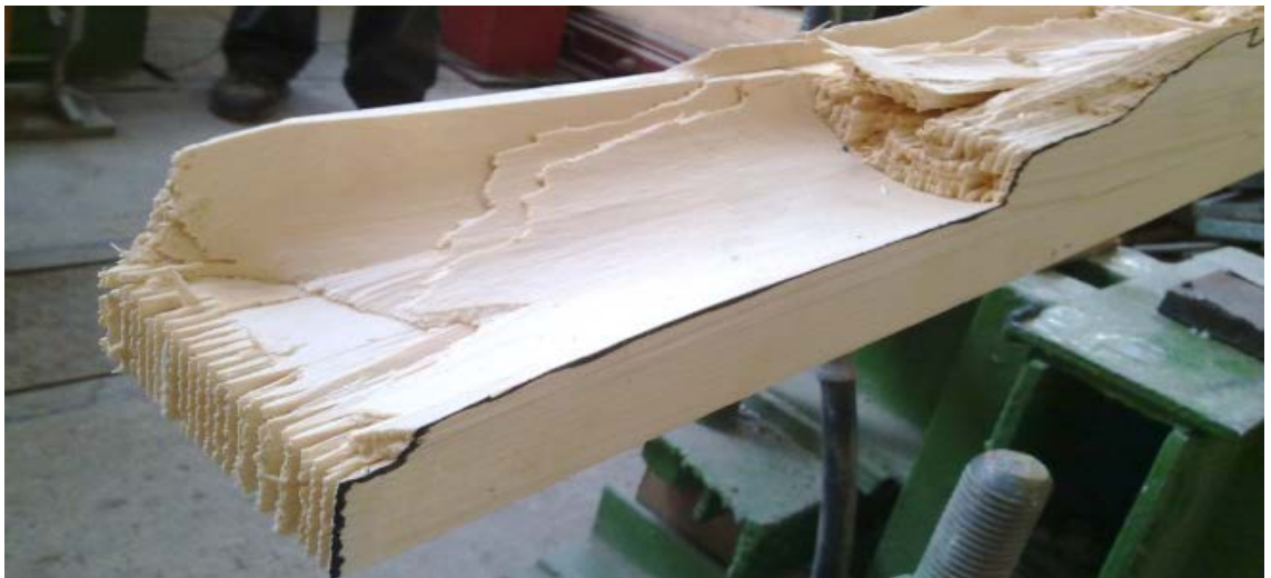
Рис. 3.5. Розрив нижньої дошки балки БД-2 по шиповому з'єднанню.
