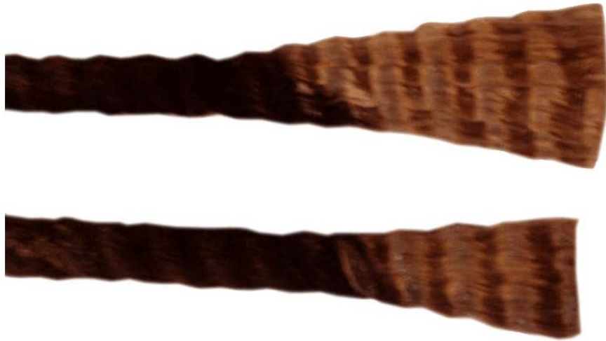
Рис. 2.20. Волокна композитної арматури без полімерної матриці.
