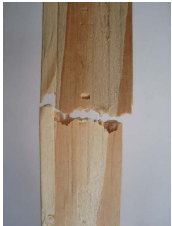
Рис. А.1. Вигляд зразків на розтяг до і після випробувань
