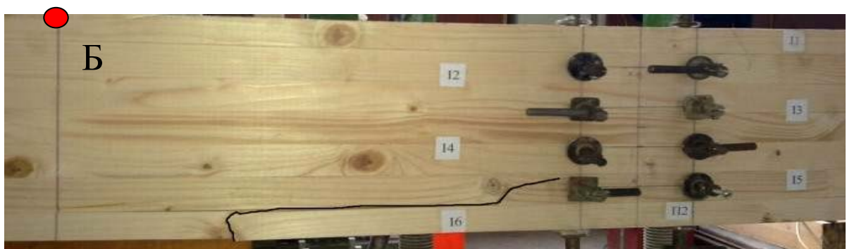
Рис. 3.3. Руйнування нижньої дошки балки БД-1 при навантаженні 0,97F_{ex,f} .
