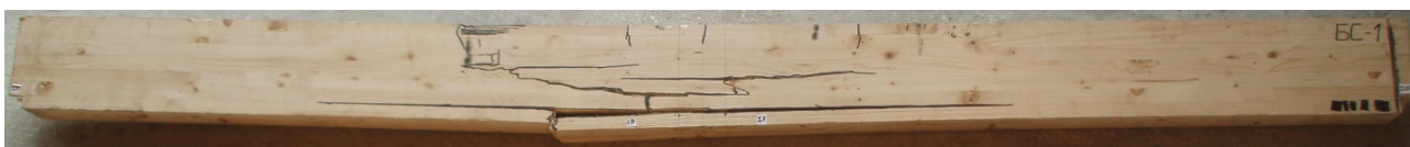
Рис. Г.3. Характер руйнування балки марки БС-1
