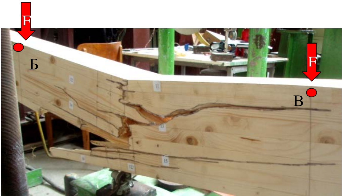
Рис. 3.4. Вигляд балки БД-1 після руйнування.
