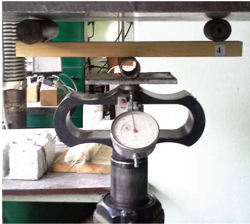
Рис. 2.18. Загальний вигляд установки для випробування дерев'яних зразків на згин.
