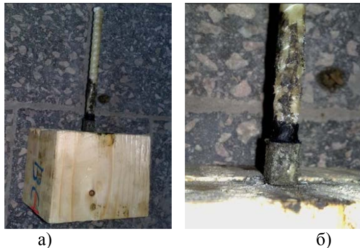
Рис. 3.29. Вигляд зразка зі склопластиковою арматурою після випробувань: а) загальний вигляд; б) вигляд висмикнутої арматури.
