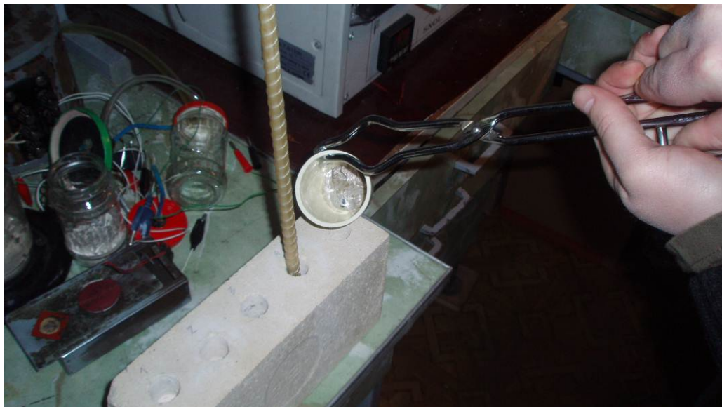
Рис. 2.21. Заливання волокон арматури розплавленим алюмінієм у керамічній формі.
