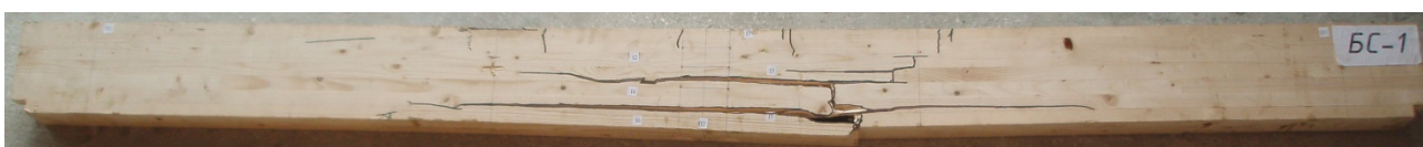
Рис. Г.2. Характер руйнування балки марки БД-2
