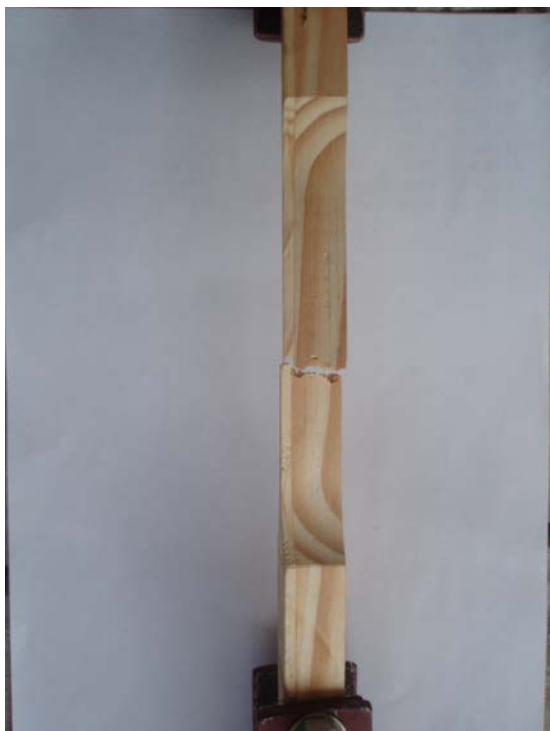
Рис. А.1. Вигляд зразків на розтяг до і після випробувань
