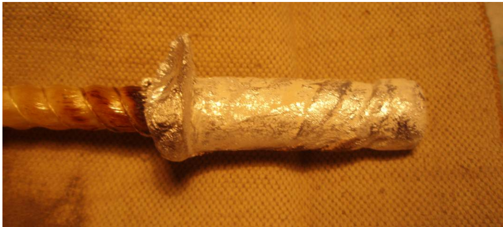
Рис. 2.22. Готовий зразок композитної арматури з алюмінієвою матрицею в опорній зоні.
