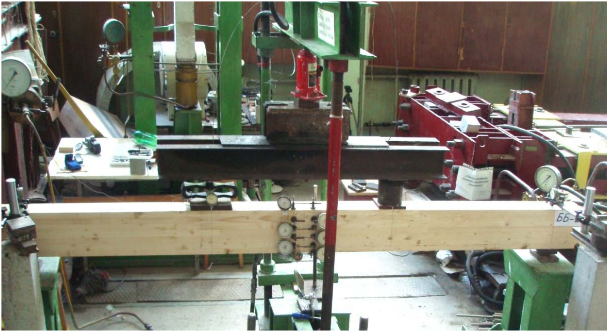
Рис.2.10. Загальний вигляд стану для випробувань балок на згин.
