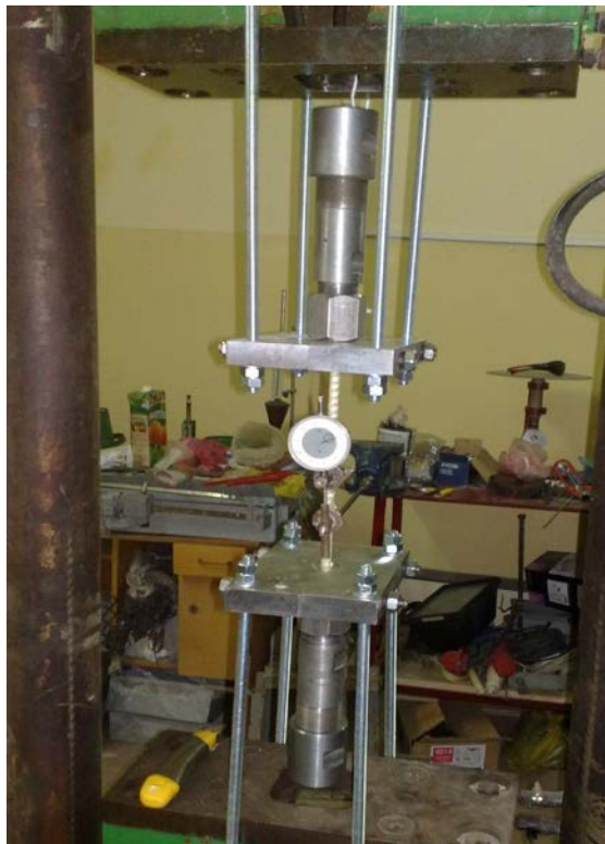
Рис. 2.26. Загальний вигляд установки для випробування композитної арматури на розтяг.
