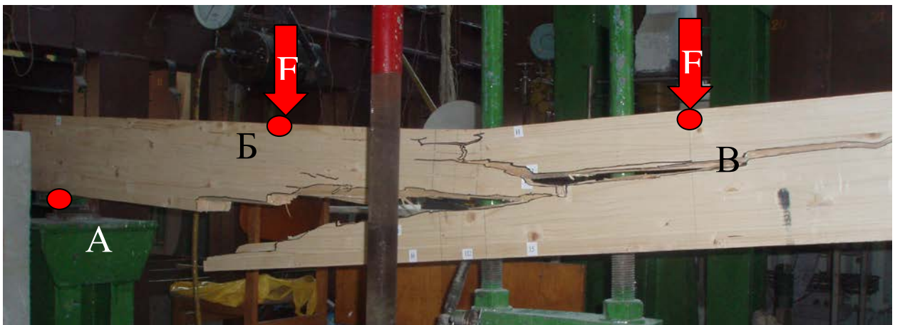
Рис. 3.6. Вигляд балки БД-2 після руйнування.
