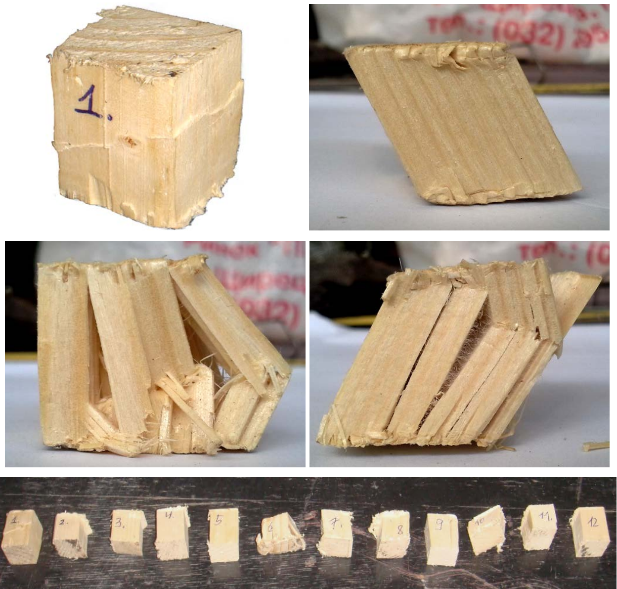
Рис. 3.36. Вигляд дослідних зразків марки ДС після руйнування.
