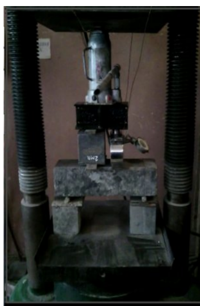
Рис. 4.14. Границя міцності на розтяг при згині самоущільнювальних бетонів з вмістом золи виносення 70 мас.% та базальтовою фіброю
