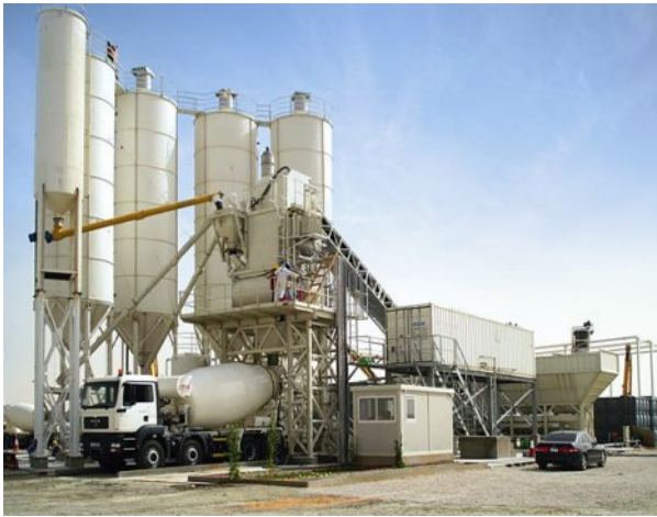
Рис. 5.2. Завантаження самоущільнювальної бетонної суміші (а) та влаштування промислової підлоги з використанням самоущільнювального дисперсно-армованого бетону (б)
