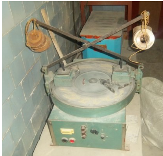
Рис. 2.10. Визначення стираності самоущільнювального бетону на крузі стирання ЛКИ-3
