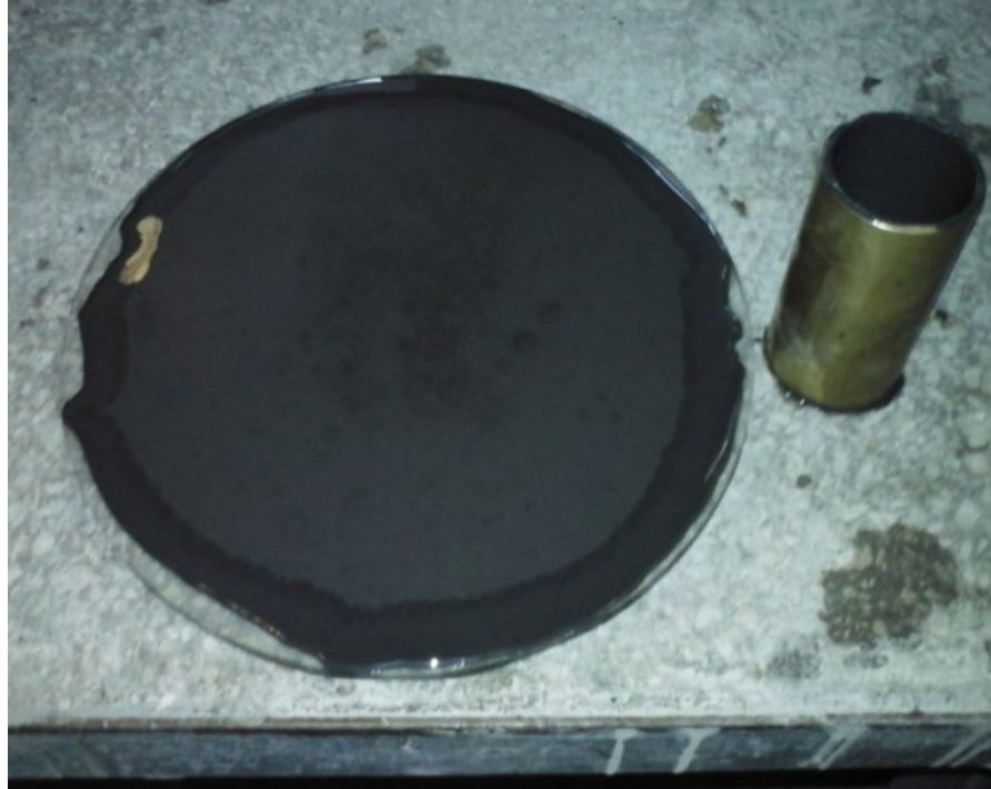
Рис. 4.4. Розплив цементного тіста за циліндром Сутгарда
