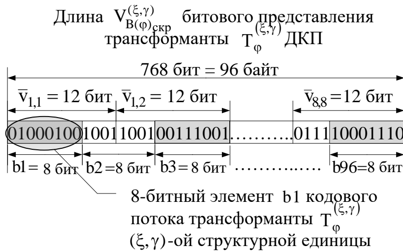
Рис. 3.10. Схема формирования элементов по 8 бит из битового потока компонент трансформанты T_{\varphi}^{(\xi, \gamma)} ( \xi, \gamma )-ой структурной единицы базового видеокadra.
