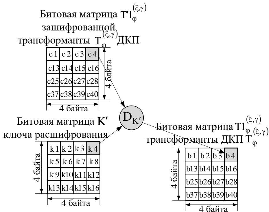
Рис. 3.18. Схема расшифровывания двоичных данных матрицы T'1_{\varphi}^{(\xi,\gamma)} из битового кода \tilde{V}_{V(\varphi)_{\text{скр}}}^{(\xi,\gamma)} компонент зашифрованной трансформанты T_{\varphi}^{(\xi,\gamma)} ДКП блока V_{\varphi}^{(\xi,\gamma)} изображения.
