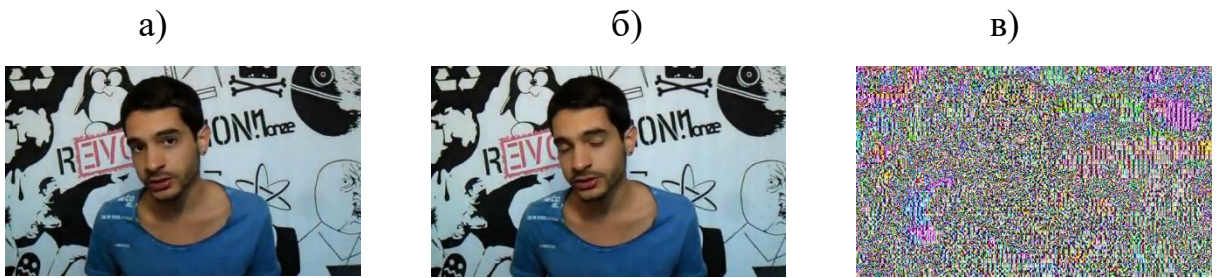
Рис. 2.13. Восстановление дифференцированного представления базового кадра при зашифрованном базовом с качеством 100%, \kappa = 1.6328 , PSNR = 6.1798 .
