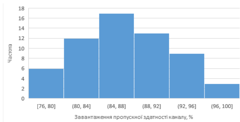
Рис. 3.16. Розподіл інтенсивності вхідного навантаження на канал між комутаторами 1 та 2
