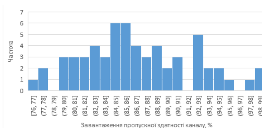
Рис. 3.18. Розподіл завантаження каналу між комутаторами 1 та 2, отриманий в результаті використання моделі моніторингу зі змінною частотою опитування
