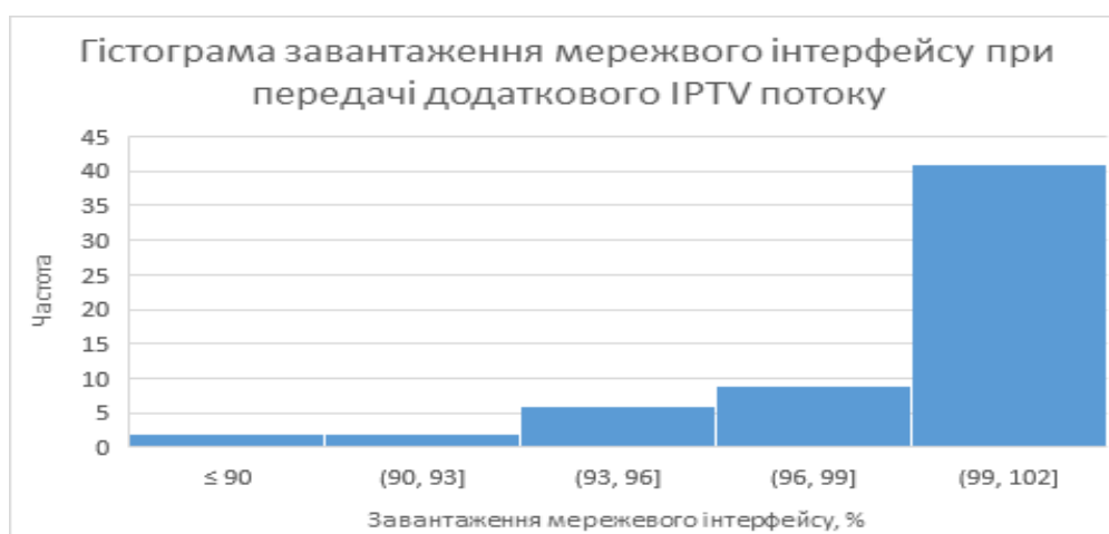
Рис. 3.19. Характеристика завантаження каналу між комутаторами 1 та 2 у випадку прокладання додаткового IPTV потоку
