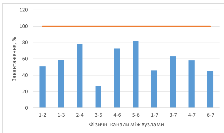
Рис. 4.10. Гістограма завантаження мережних каналів унаслідок маршрутизації фонового навантаження за допомогою протоколу EIGRP
