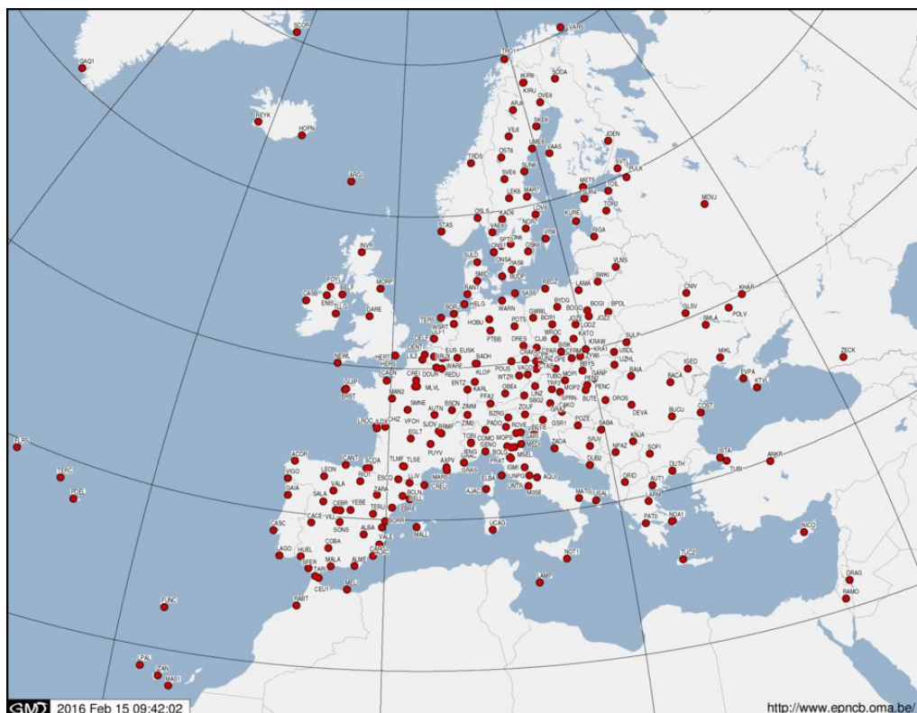
Рис. 1.4.2 Схема мережі постійних станцій EPN на території Європи
