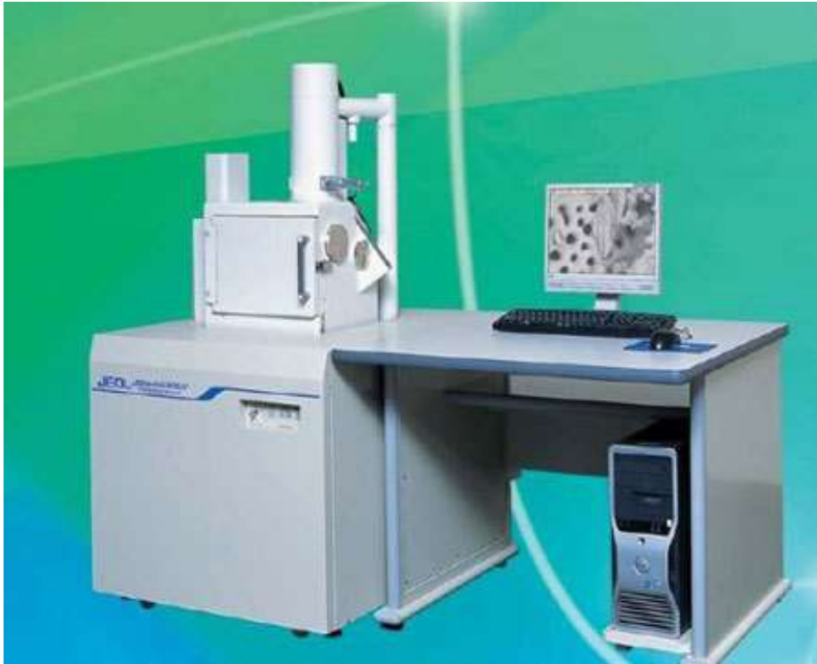
Рис. 2.3. Скануючий електронний мікроскоп JSM-6490 LV з приставкою EDS
