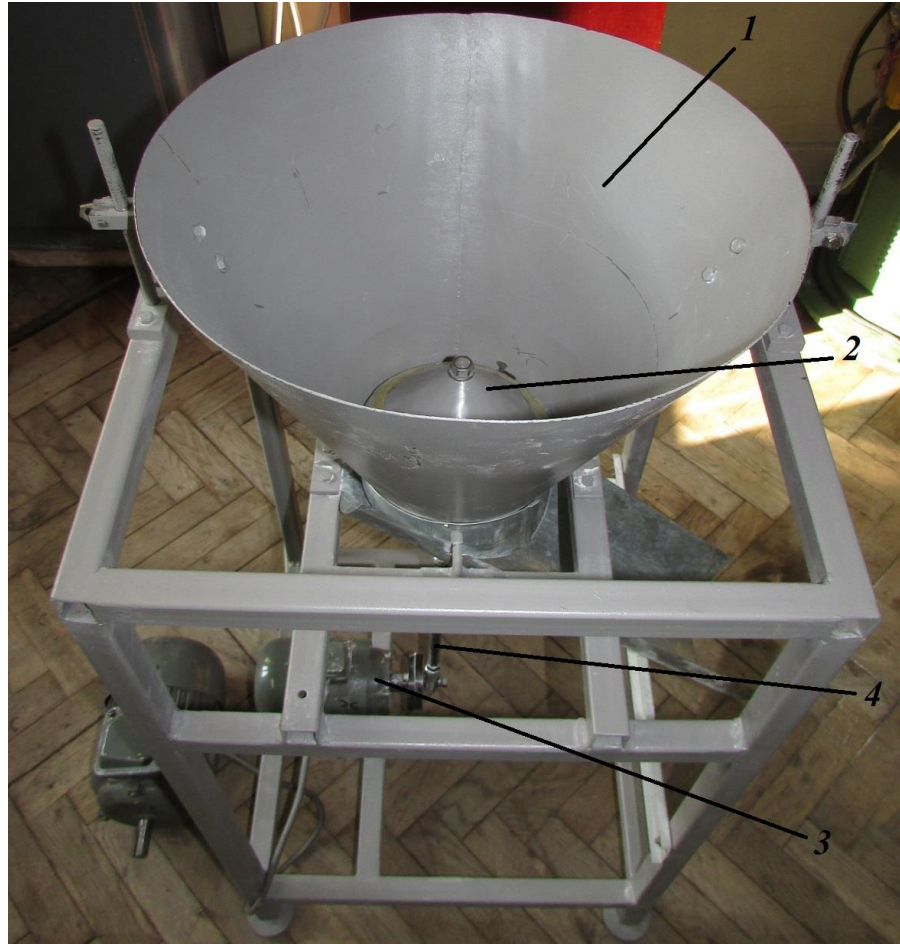
Рис. 3.2. Експериментальна установка вібраційного об'ємного дозатора
