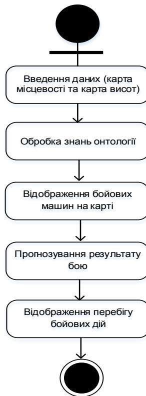
Рис. 3.24. Блок-схема імітаційного моделювання
