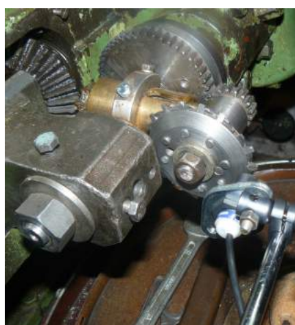
Рис.5.7. Робочий простір верстата з здавачем для вимірювання сили різання на збірній фрезі
