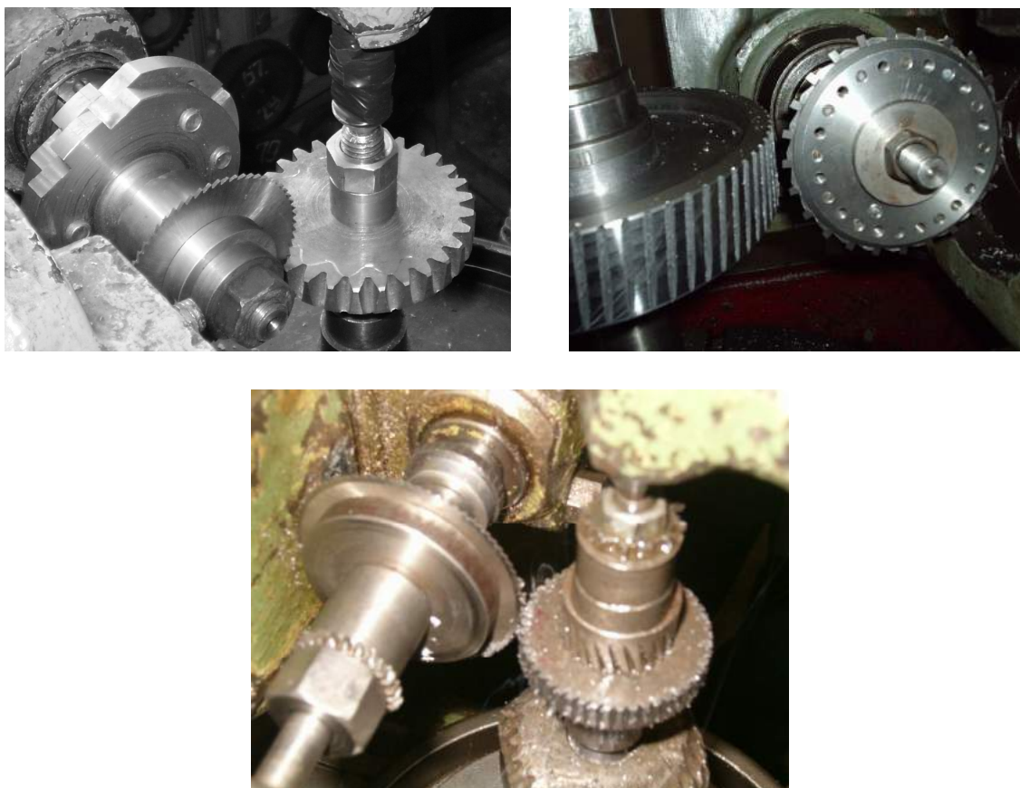
Рис.1.2. Нарізання синусоїдальних зубчастих коліс: а, в - фрезами із швидкорізальної сталі; б – збірною фрезою з зубцями із твердого сплаву
