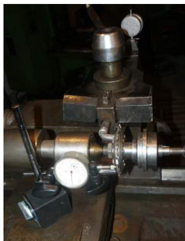
Рис.5.4. Тарування збірної дискової фрези з пластинами з твердого сплаву ТК: а – вимірювання деформації фрези; б – вимірювання сили навантаження
