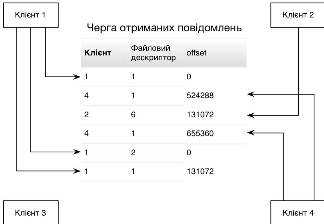
Рис. 3.10. Мультиплексування з одним вузлом, розроблено самостійно.
