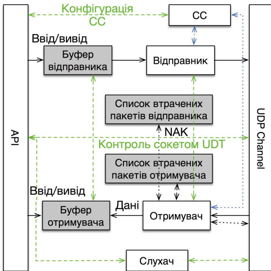
Рис. 3.4. Функціональна структура протоколу UDT.
