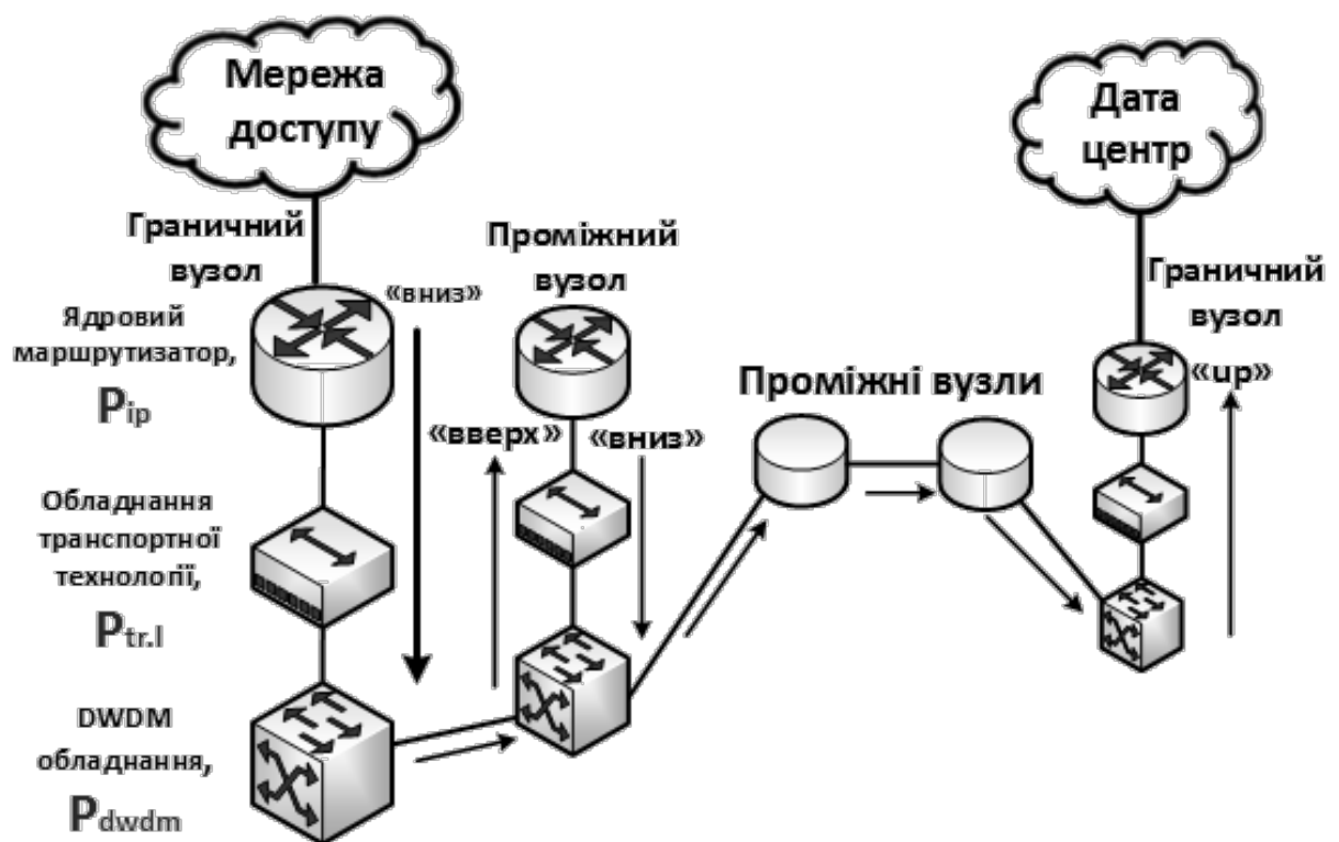
Рис. 4.2. Трьохрівнева структура транспортної телекомунікаційної мережі
