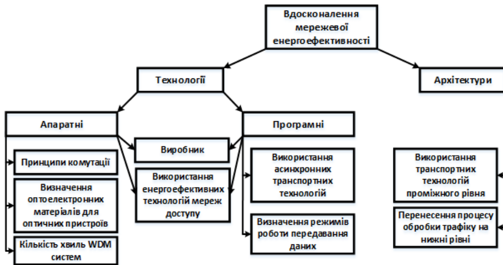
Рис. 1.4. Принципи підвищення енергоефективності для технологічних і архітектурних підходів
