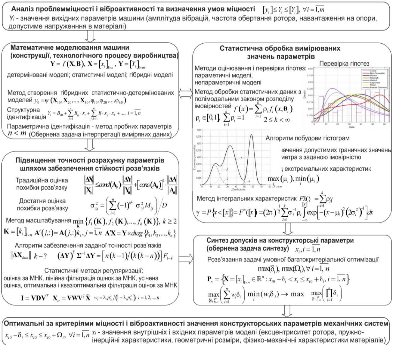
Рис. 4.10. Комплексна методика розв'язання оптимізаційних ОЗ синтезу конструкторських параметрів МС за критерієм міцності і віброактивності
