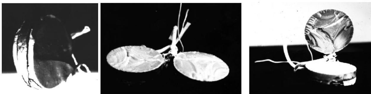
Рис. 1.7. Поверхня руйнування кераміки конденсатора
