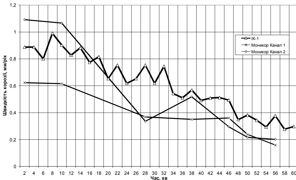
Рис. 25 – Результати випробовування розробленого ІВС для контролю швидкості корозії в порівнянні з існуючими аналогами
