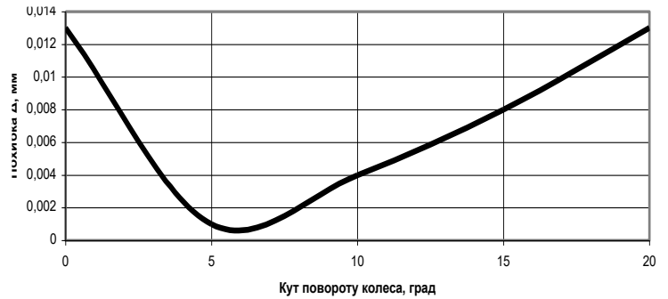
Рис. 3. Залежність похибки \Delta при повороті ведучого колеса на один кутовий крок 20^\circ при z_1 = 18
