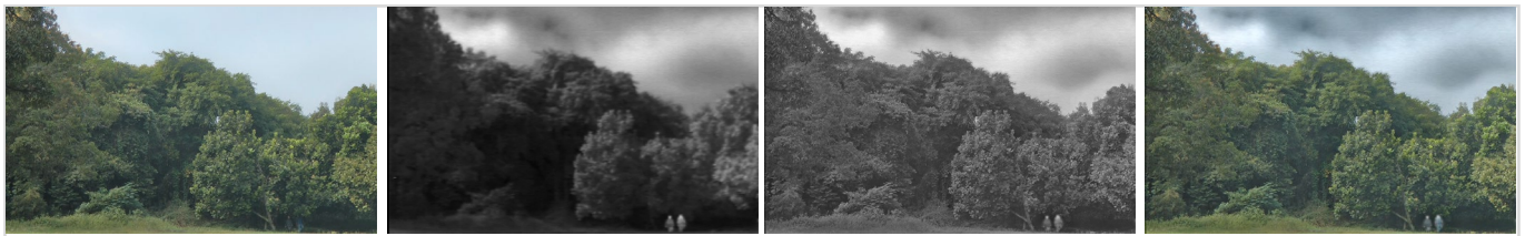
Рис. 9. Комплексування зображень з урахуванням розподілу кольорів: а) вхідне зображення видимого діапазону; б) вхідне зображення ІЧ діапазону с) комплексоване в градаціях сірого; д) комплексоване з урахуванням розподілу кольорів на зображенні видимого діапазону
