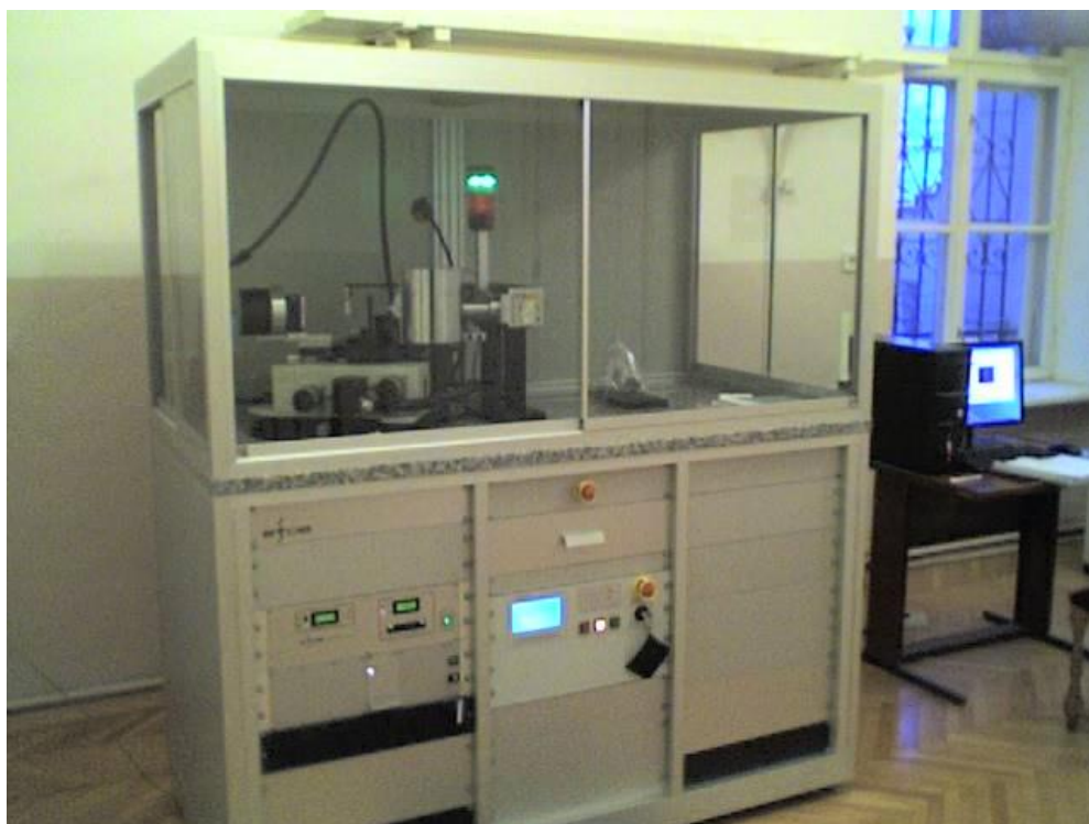
Рис. 2.10. Рентгенівський дифрактометр STOE STADI P.
