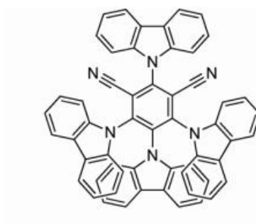
Рис. 1.11. Типовий ТАДФ випромінювач 4CzIP [82]
