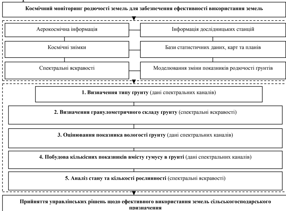
Рис. 1. Узагальнена схема системи космічного моніторингу родючості ґрунтів на землях сільськогосподарського призначення.
