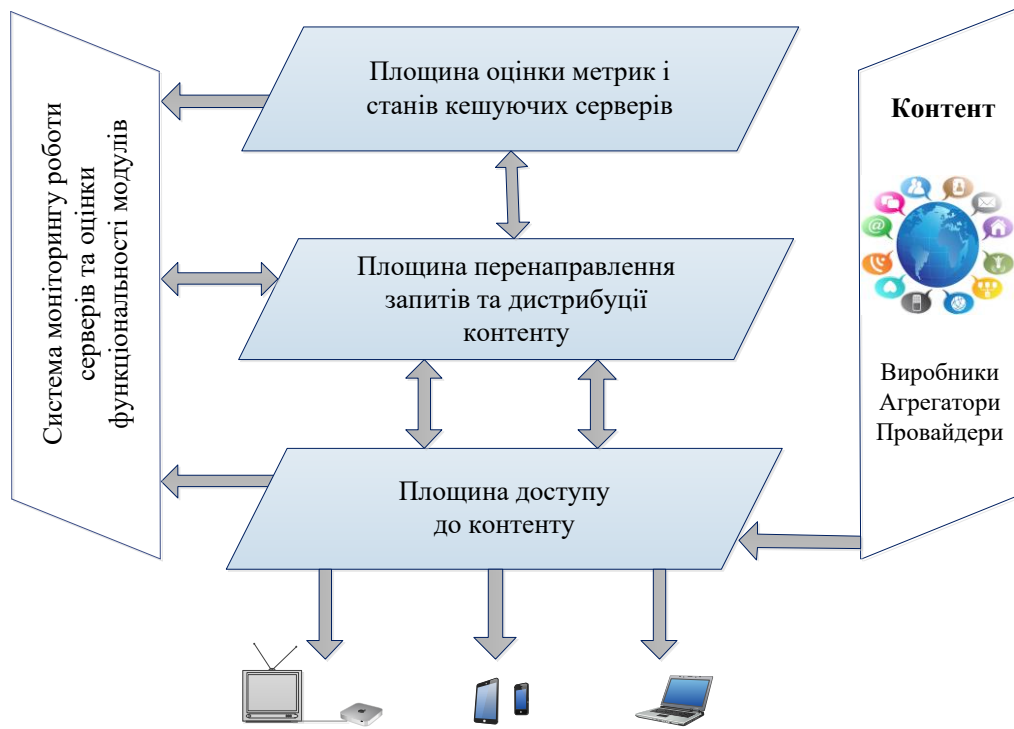
Рис. 16. Багаторівнева модель функціонування мережі доставки контенту.
