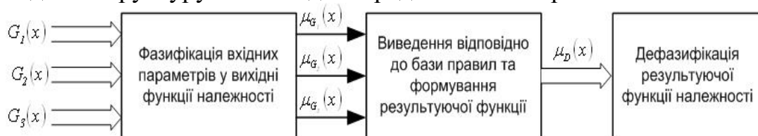
Рис. 8. Структура реалізації нечіткої моделі БКО вибору базової МФ
