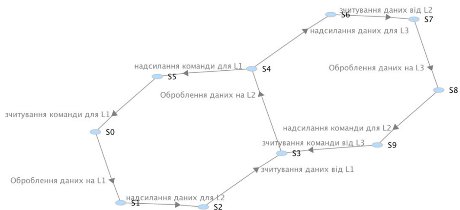
Рисунок 3.10 – Граф досяжності станів під мережа Петрі комунікації та взаємодії рівнів
