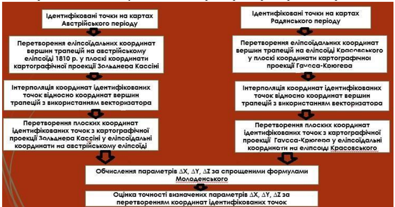
Рис. 4. Схема визначення параметрів перетворення координат
