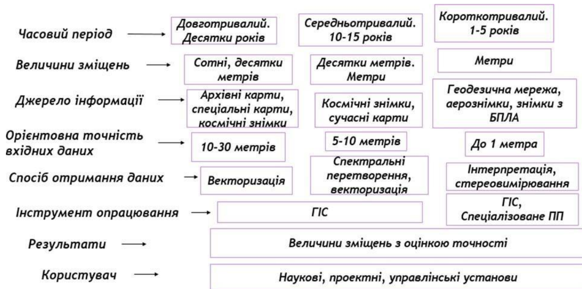
Рис. 1. Концептуальна модель дослідження горизонтальних зміщень річок
