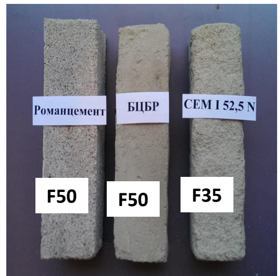
Рисунок 5.20 – Розподіл пор за об'ємом штукатурного розчину на основі БЦБР 200 та зразки штукатурного розчину після поперемінного заморожування та відтаювання
