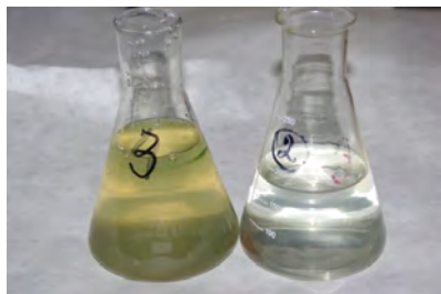
Вихідна болотна вода (зліва) і після очищення за допомогою установки (справа)
