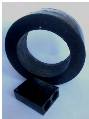
Комплектуючі деталі мікронагнітача МК 10-1 (ротор 90×60×34, пластина)
