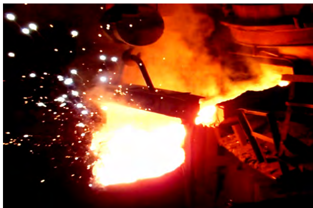
Процес позапічної десульфурації чавуну магнієм, відновленим з оксиду в об'ємі розплаву за рахунок тепла паралельних хімічних перетворень
