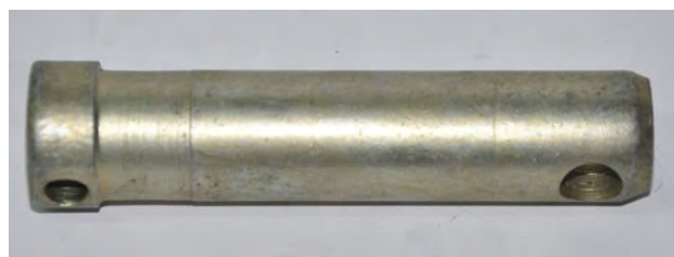
Втулка і палець із нанесеним зміцненим покриттям
