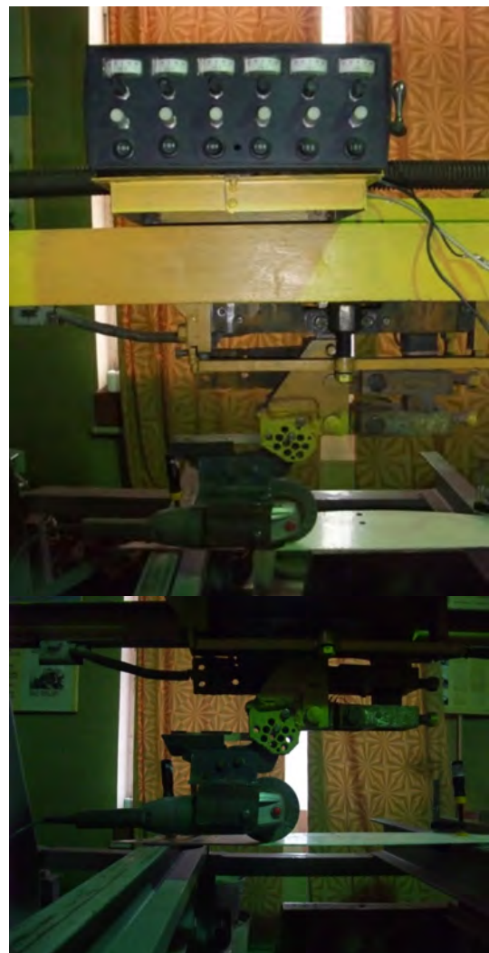
Робоче обладнання, закріплене на стенді для вимірювання сили очищення поверхонь
