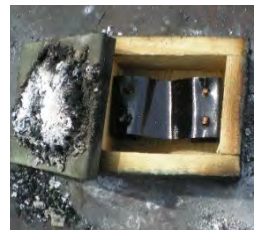
Випробування модельного зразка тари, обробленого захисним покриттям, при дії полум'я магнію
