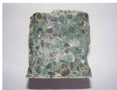
Руйнування заповнювача після випробування бетону
