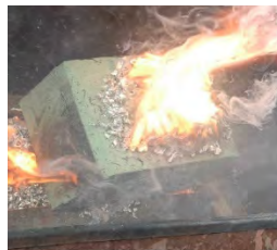
Випробування модельного зразка тари, обробленого захисним покриттям, при дії полум'я магнію
