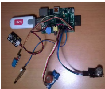
Макет вузла БСМ для дистанційного моніторингу температури та вологості за допомогою сенсорного датчика
