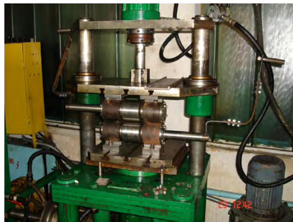
Експериментальний зразок установки з гідроімпульсним приводом для віброударного зневоднення відходів харчових виробництв
