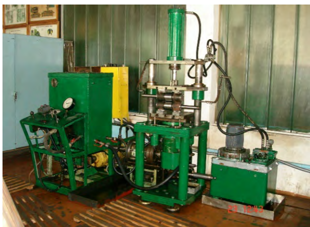
Експериментальний зразок установки з гідроімпульсним приводом для віброударного зневоднення відходів харчових виробництв
