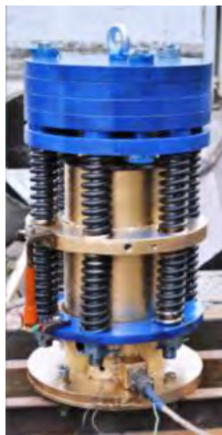
Вібранурювач на основі коаксіально-лінійного двигуна з постійними магнітами
