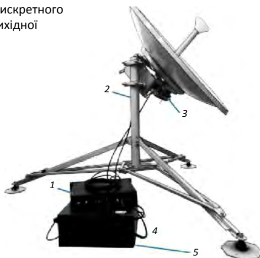
1 – пристрій модемний; 2 – пристрій антенно-поворотний; 3 – блок приймально-передавальний; 4 – бухта кабелів; 5 – блок живлення
